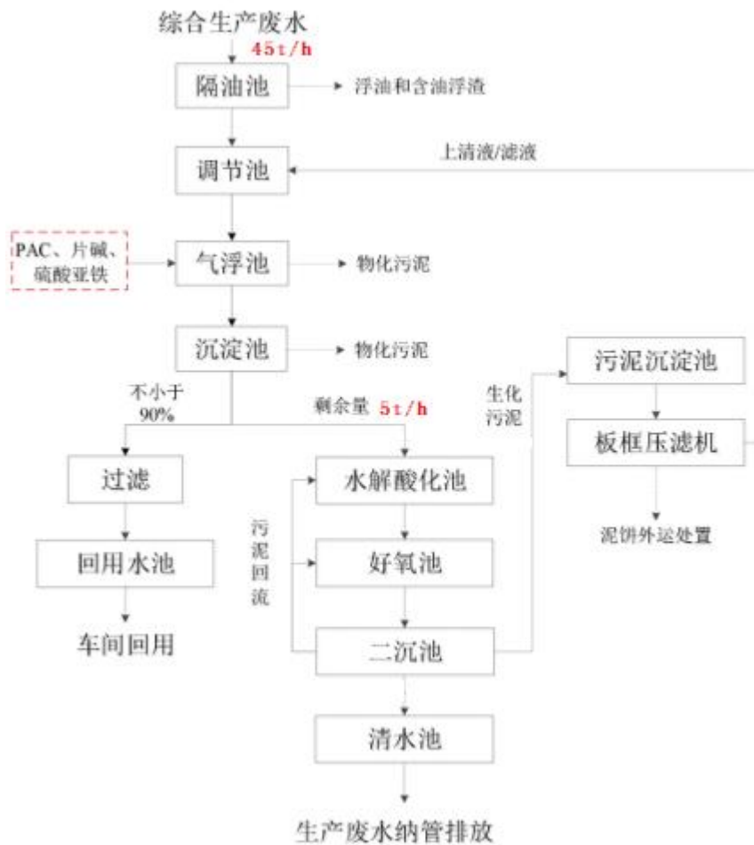
图 4-1 污水处理站处理工艺图
