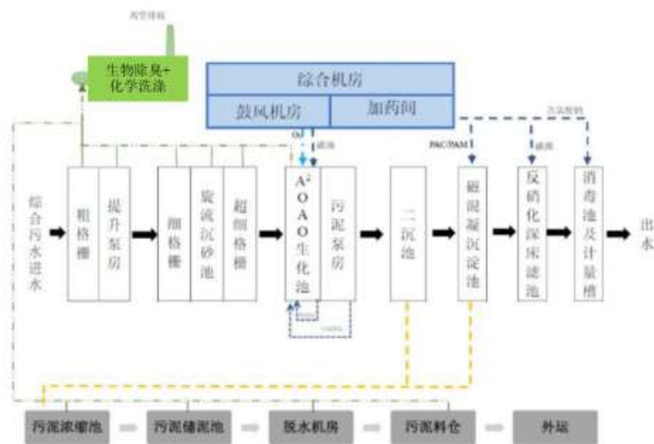
图 4-3 南片污水处理厂（2023 年环评审批）污水处理工艺流程图
